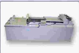
Filtro con separador para filtrado de tres rectificadoras
